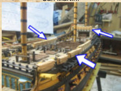
(7) Batayolas (ver flechas blancas). Barandillas situadas a lo largo del pasamano y alrededor de las cubiertas de los castillos y superestructuras de un barco.
